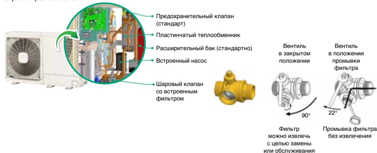
Шаровый кран имеет встроенный сменный фильтр, с удобным доступом для обслуживания. Данная конструкция имеет очевидные преимущества с точки зрения стоимости, монтажа и пространства, помимо очевидных преимуществ с точки зрения стоимости, монтажа и пространства, так как традиционно используется три компонента — один фильтр и два запорных клапана.
